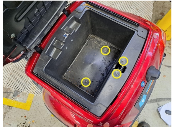
Irrota säilytyslokeron kiinnityspultit. (hylsy 8 mm).
