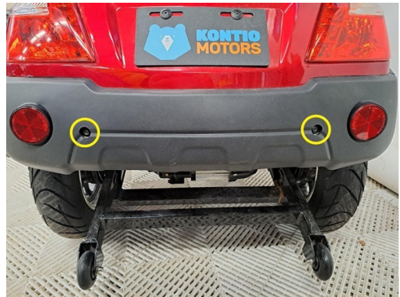
Irrota takakatteen kaksi kiinnityspulttia. (hylsy 8 mm).
