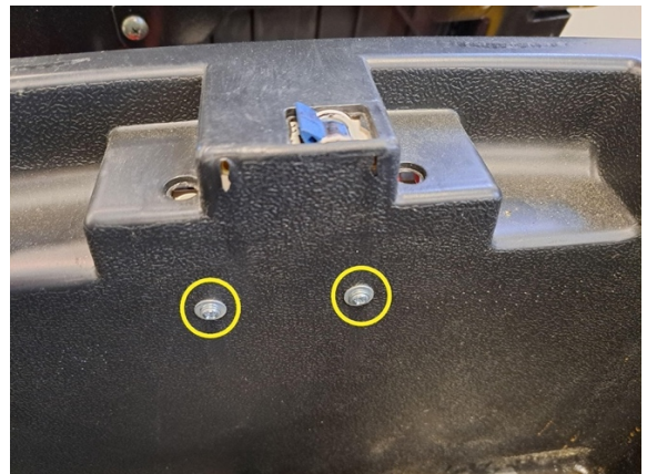
Irrota päävirtakatkaisijan kaksi kiinnitysruuvia. (ristipäämeisseli ph2).
