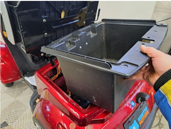
Nosta säilytyslokero ylös.
